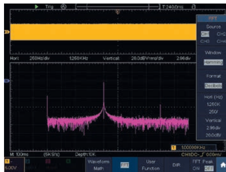
Рис. 15. Спектрограмма сигнала в режиме БПФ
