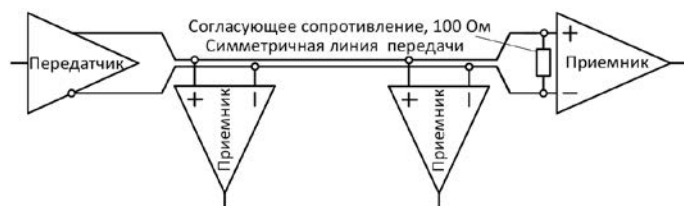
Рис. 4. Подключение нескольких приемников к одному передатчику LVDS
