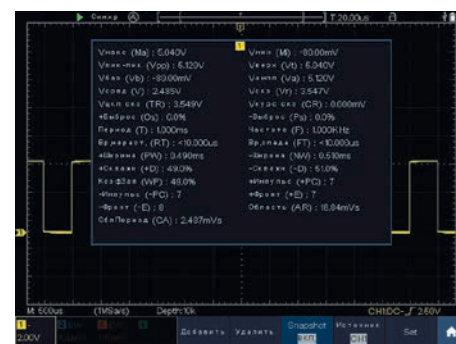
Рис. 12. Отображение результатов автоизмерения
