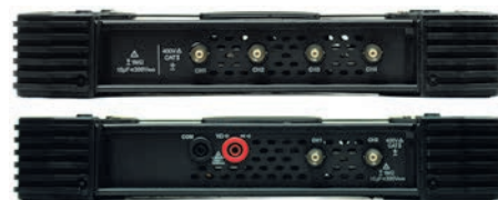
Рис. 2. Входные разъемы 4- и 2-канальных моделей
