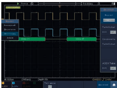
Рис. 14. Декодирование сигналов последовательных шин
